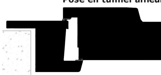
Pose en tunnel affleurant
