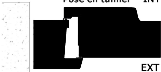
Pose en tunnel INT
